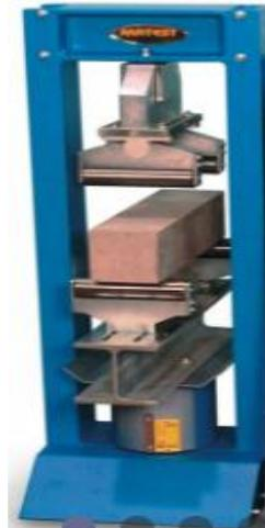
Fig. (5). a: Compressive test machine.
